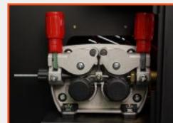
El doble sistema de arrastre en una máquina de soldar sirve para alimentar el alambre de soldadura con mayor fuerza y precisión.
